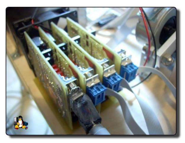
Im Sommer 2005 hab ich die Elektronik ueberarbeitet. Nun ist die Zahl der ICs halbiert und es koennten 4 Motoren gesteuert werden. Allerdings bleibe ich bei drei und nutze den 4.Anschluss fuer das Festplattenmagnet das ist beim Zeichnen vieeel schneller als alle Motoren. Die 3.Achse verwende ich nur zum Bohren bzw den Stift einstellen. Da sich auch die Platienengroesse halbiert hat und die Spannungsregler (und zu kleine Kuelkoerper) nun auch noch mit drauf sind ist ein Luefter nun Pflicht.
